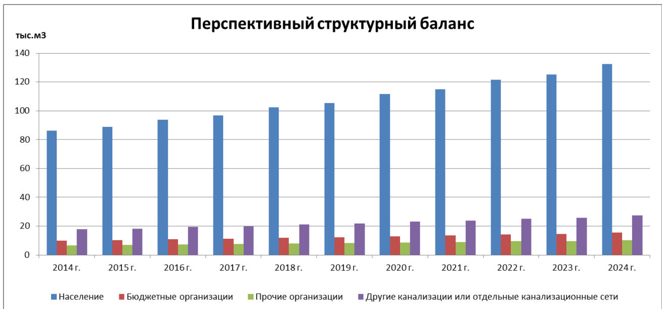
Рис. 11.1. – Структурный график изменения поступления сточных вод в централизованную систему водоотведения на период 2014-2024 гг.
